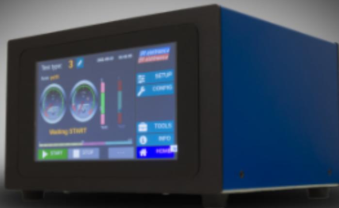
Il principio applicato consiste nella misura di un'eventuale calo di pressione sul componente in prova dopo averlo portato ad una pressione nota
